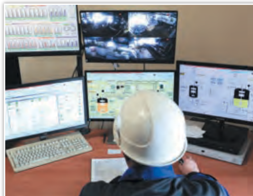
Аппаратчик полимеризации управляет процессом производства на линии акриловой дисперсии в цехе № 19 АО «Пигмент» в Тамбове
