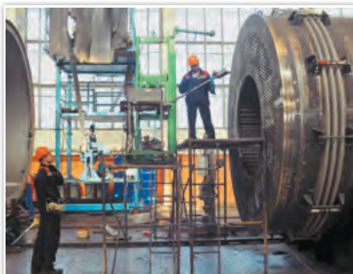
Сборка теплообменника для нефтегазовой промышленности. АО «ЗАВКОМ». Тамбов. Фото А. Сухорукова
